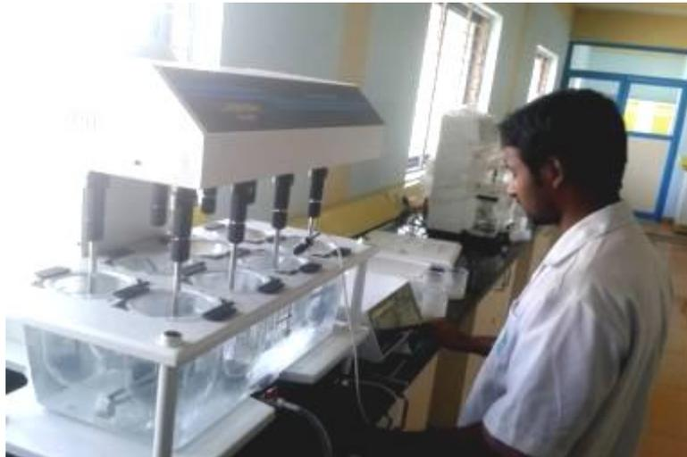
**DISINTEGRATION TEST APPARATUS**
